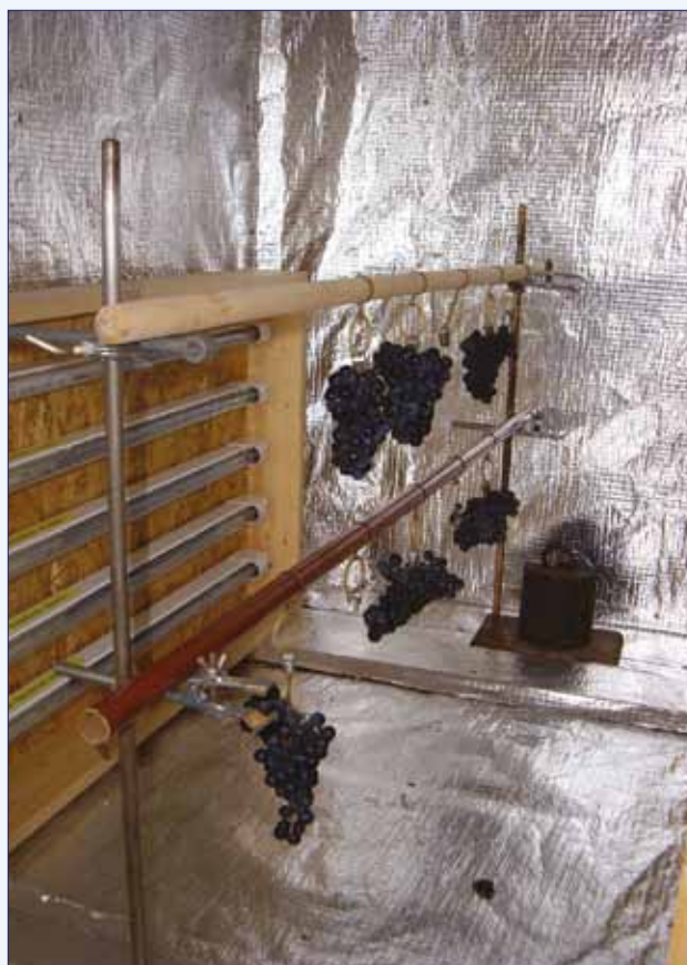
Obrázek 1. Provedení poloprovazního UV ozařovacího zařízení
